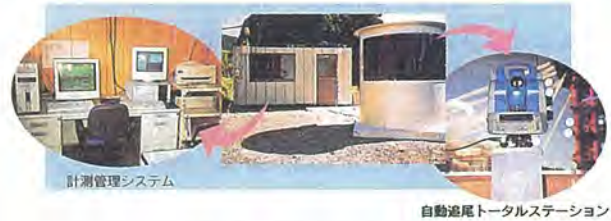
写真-3 自動計測システム
